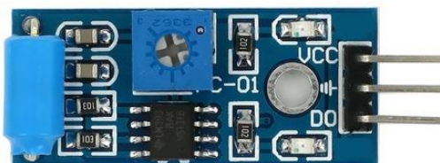
Fig 3.6.3: Vibration Sensor Module (SW-420)
