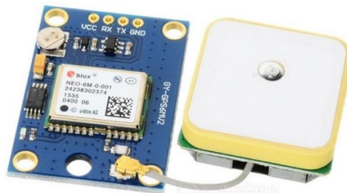
Fig 3.6.2: GPS Module (NEO-6M)
